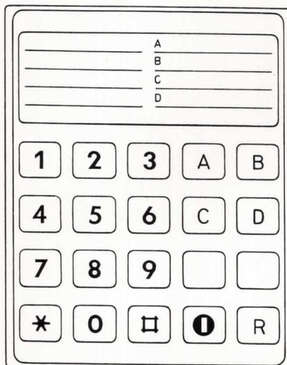
Das Tastwahl-Telefon T 40 MFV ist an alle Fernsprechanlagen mit MFV-Wahl anzuschließen. Zusätzlich zur Wähltastatur verfügt das Telefon über vier Programmtasten für Leistungsmerkmale einer Nebenstellenanlage nach Ausstattungsvorschrift 2.
