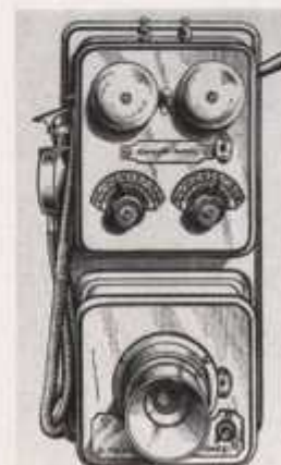
Abb. 153 USA-Apparat System Callender aus dem Jahr 1895 mit Umschaltern für zweistellige Zahlen, Hörer, Mikrophon und Anrufhebel (oben rechts)
