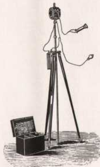
Bild 128 Telefonapparat (Abhörgerät) zum Anzeigen undichter Stellen in Wasserleitungsrohren. 1887
