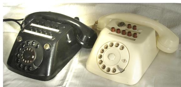
Die Vielfalt der „E 1“-Apparate ist nicht nur in einer elfenbeinfarbenen Variante ersichtlich, sondern auch in den Reihenmodellen.
