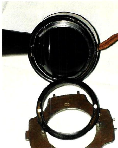
Die breiteren Stifte des Werkzeuges setzen sich zentrisch auf den Ring der Mikrofonverschraubung
