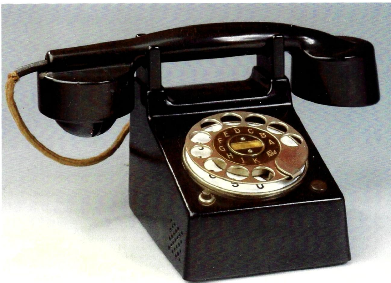
Die Standardausführung aus schwarz-lackiertem Stahl- oder Messingblech mit Schallaustrittslöchern für den Wecker (Eine Vorserie aus schwarz-lackiertem Stahlblech ohne Schallaustritt ist besonders selten anzutreffen)
