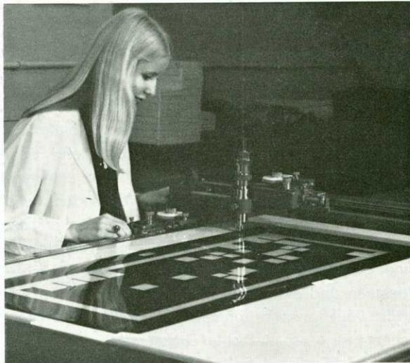
BILD 1 Koordinatograph zum Herstellen der Originalvorlage im Maßstab 20:1
