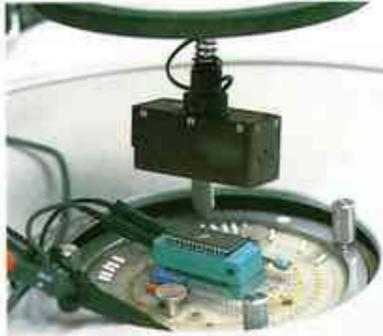
geringem Instandhaltungsaufwand, langer Gebrauchsdauer und niedrigem Platzbedarf erfüllt EWSD u. a. durch den Einsatz hochwertigster Bauelemente. Voraussetzung für den Einsatz von Bauelementen in EWSD sind Zuverlässigkeitstests, zum Beispiel Burn-in-Tests.
