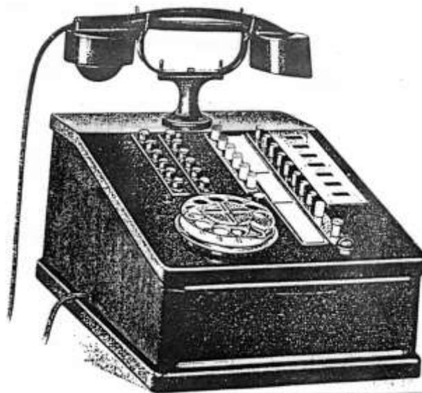
Mit den Universalzentralen wurde die Forderung nach der "vollautomatischen" Gestaltung des Fernsprechverkehrs bis auf die Vermittlung des ankommenden Amtsverkehrs erfüllt. Alle sich im Verkehr ergebenden Vorfälle, wie Herstellung von Verbindungen im Amts- und Hausverkehr, Rückfragen während einer Amtsverbindung bei anderen Teilnehmern derselben Anlage oder
