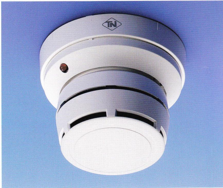
Der optische Rauchmelder BR 10 arbeitet nach dem Rückwärts-Streulichtverfahren und reagiert auf sichtbaren Rauch. Eine Leuchtdiode und eine Photozelle sind in einer Meßkammer so angeordnet, daß kein Licht auf die Photozelle fallen kann.
