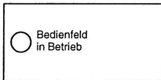
Grünes Dauerlicht zeigt an, daß die Versorgungsspannung an den entsprechenden Klemmen zur Verfügung steht.
