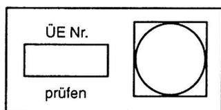
Taster zur Überprüfung der elektrischen Auslösbarkeit der ÜE (Probealarm). Die elektrische Auslösung ist nicht bei abgeschalteter ÜE wirksam. In das weiße, von Hand beschriftbare Feld muß die Nummer eingetragen sein, unter der die Brandmeldeanlage bei der Feuerwehr angeschaltet ist.
