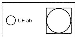
In der eingerasteten Stellung des Tasters ist die Übertragungseinrichtung ÜE abgeschaltet.
