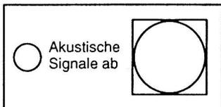
Taster schaltet die Örtliche Alarmierung (bzw. Steuergruppe) und die Internakustik der Brandmelderzentrale ab. Die Internakustik der BMZ ist nur solange abgeschaltet, wie keine weiteren Meldungen angezeigt werden. Durch erneuten Tastendruck wird die Abschaltung der Örtlichen Alarmierungseinrichtung aufgehoben.
