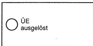
Gelbes Dauerlicht zeigt an, daß die Feuerwehr durch Auslösen der Übertragungseinrichtung alarmiert wurde.
