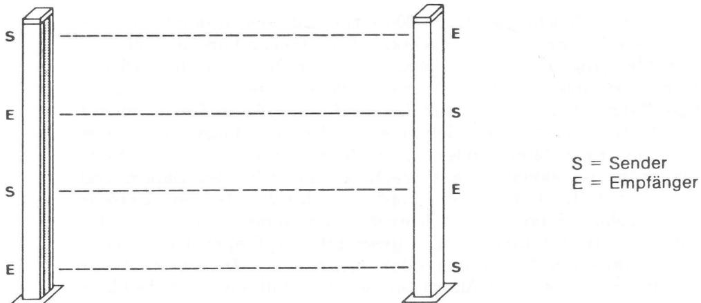
Für die Projektierung sind die Mindestabstände der Sender/Empfänger-Kombinationen in den Säulen, wegen der Beeinflussung durch die Streuung der Infrarotstrahlen, zu beachten. Nähere Hinweise siehe T-Teil 7.2.7.3.5, Abschnitte von 2.2.3 bis 2.2.8.
