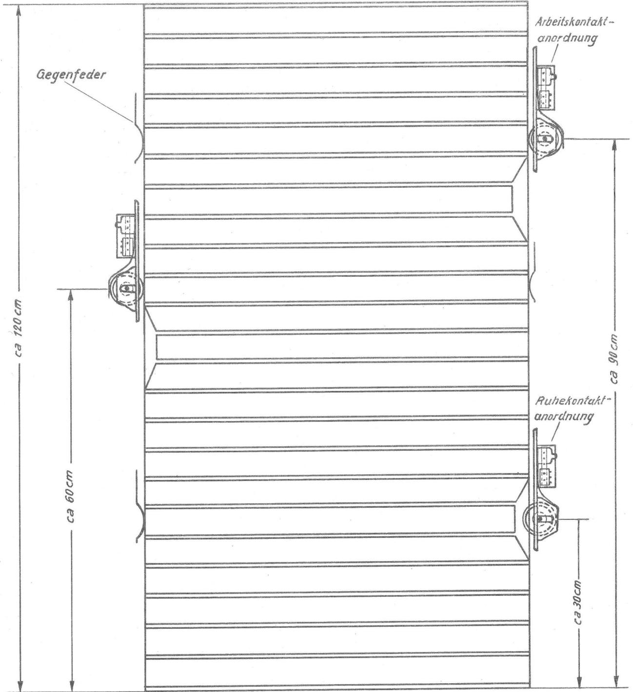
Diese Maße werden vorgeschlagen bei einer Rolladenhöhe von ca 120 cm.
