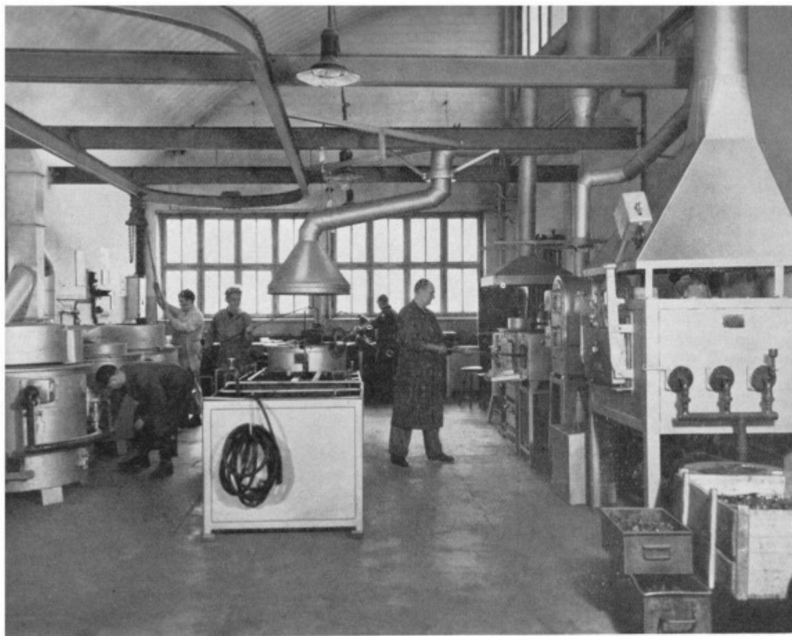
**Aufkohlen, Härten oder Anlassen** gehört zu den Spezialitäten unserer Härtereien des Werkzeugbaues. Im Glühofen und im Salzbad werden die Werkzeuge erhitzt und anschließend je nach der Natur des Stahles abgekühlt, abgeschreckt oder im Sand langsam wieder auf Zimmertemperatur gebracht. Genaue Werkstoffkenntnis und reiche Erfahrungen verhüten ein Verziehen der teuren Werkzeuge und garantieren die Maßhaltigkeit.
