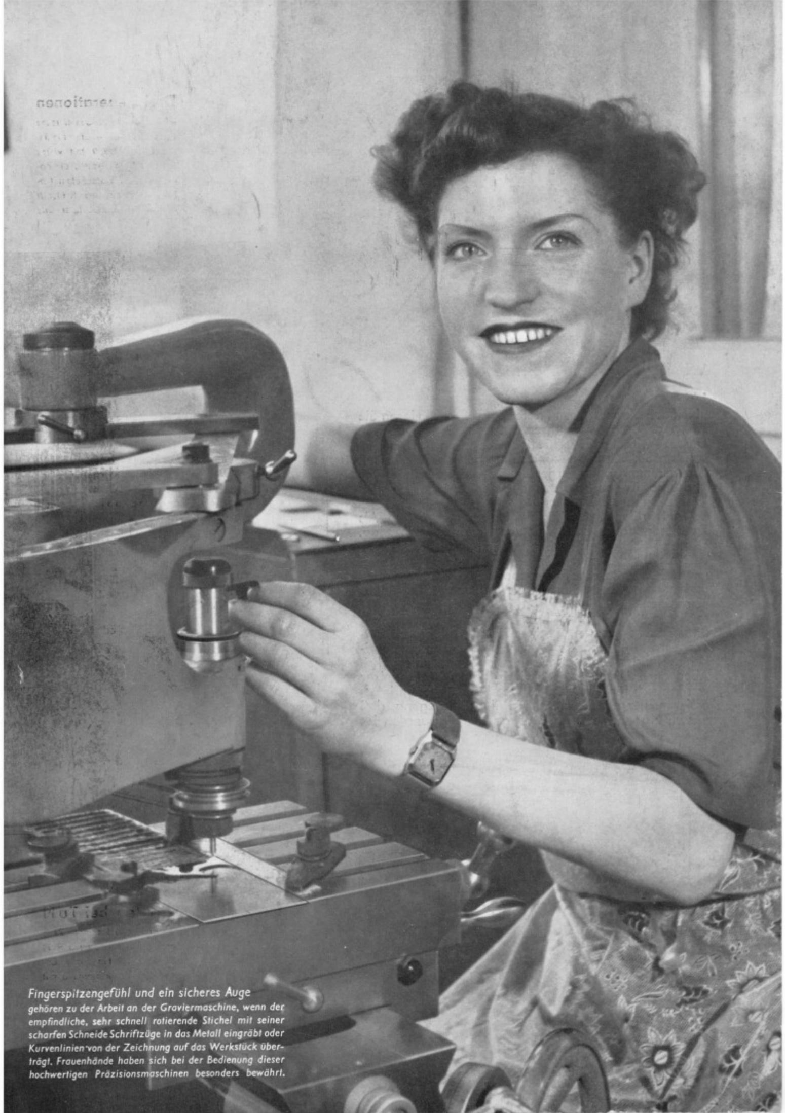
Fingerspitzengefühl und ein sicheres Auge gehören zu der Arbeit an der Graviermaschine, wenn der empfindliche, sehr schnell rotierende Stichel mit seiner scharfen Schneide Schriftzüge in das Metall eingräbt oder Kurvenlinien von der Zeichnung auf das Werkstück überträgt. Frauenhände haben sich bei der Bedienung dieser hochwertigen Präzisionsmaschinen besonders bewährt.
