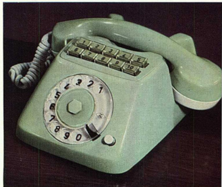
Der TuN-Schnellrufapparat mit 10 Schnellruftasten für den Chef
