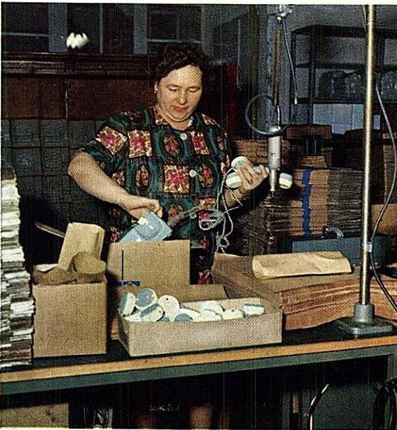
BILD 4 Das Verpacken ist als letzter Arbeitsvorgang dem Takt des Fließbandes angegliedert
