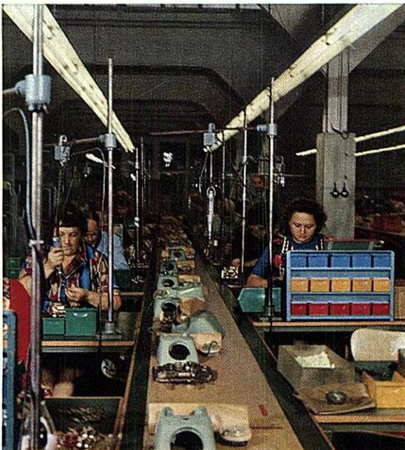
BILD 5 Gesamtbild des Fließbandes für die Montage von Fernsprechapparaten
