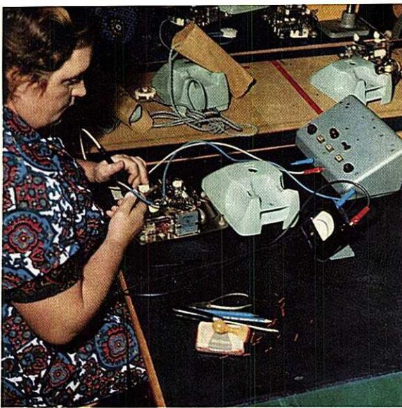
BILD 3 Zwischenkontrolle am Fließband
