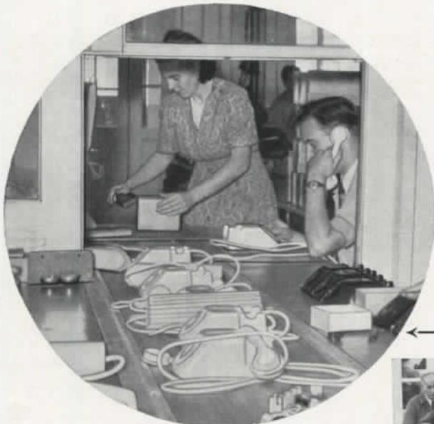
Direkt vom Fließband wandert der fertige Telefonapparat zur Funktionskontrolle und wird dann sofort verpackt
