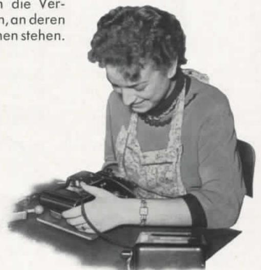
Zwischenprüfung des Telefonapparates am Fließband mit Prüfgehäusen
