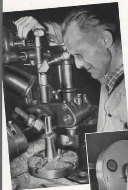
*Unter Kontrolle durch das Mikroskop bearbeitet die Stempelhoblermaschine das Werkstück*
