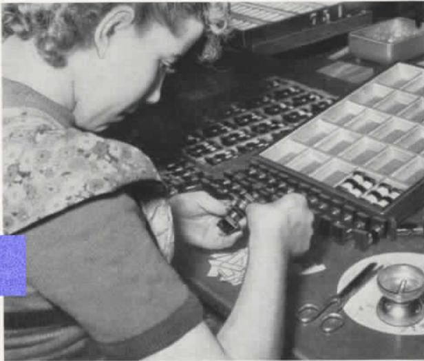
Hier werden die Weckerspulen mit Bezeichnungstreifen versehen und in Kästen eingeordnet, die dann zum Fließband wandern
