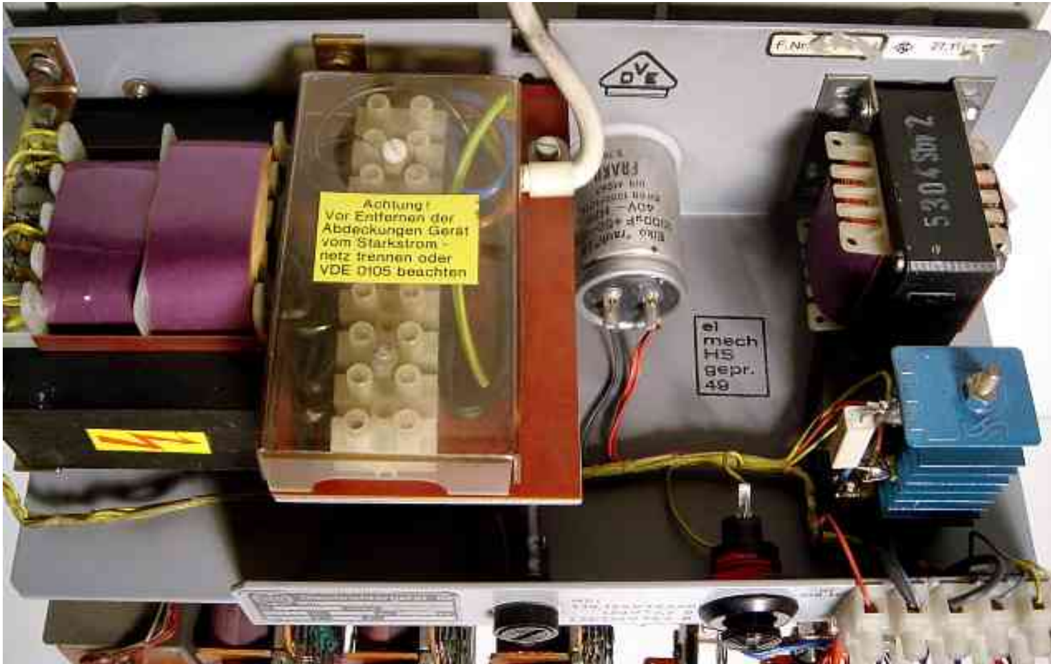
Rechts: Siebdrossel, Graetz-Selengleichrichter mit seitlichem Grundlastwiderstand
