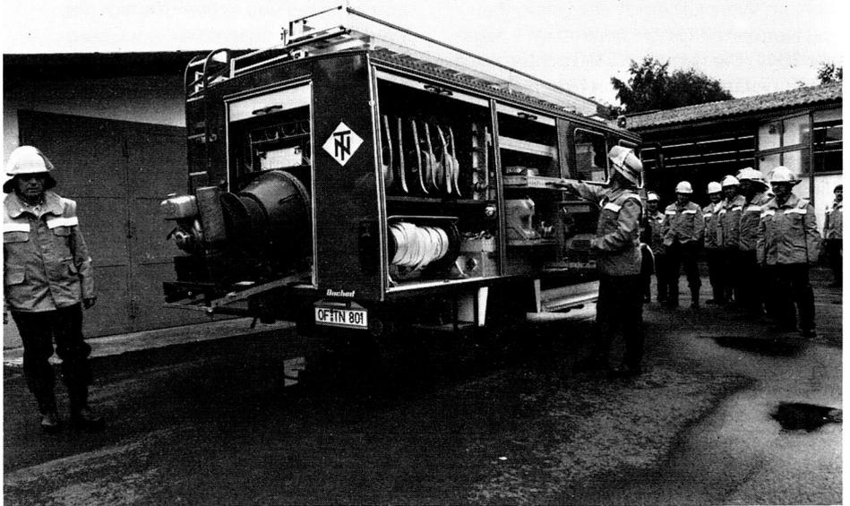
Löschgruppenfahrzeug LF 8 mit ausgefahrenem Leichtschaumgenerator
